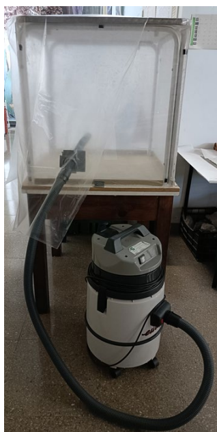
Fig.6. Entrada del mànec de l'aspirador a la Cabina B.
