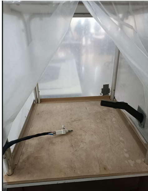
Fig.7. Imatge del tub de l'aspirador introduït dins la cabina, juntament amb el llapis de projectar.
