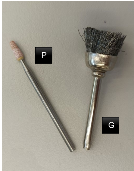
Fig. 4. Imatge de dos accessoris amb tija de diàmetre petit (P) i tija de diàmetre gran (G).
