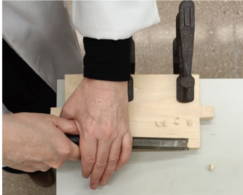
Fig. 4 Imatge del moment de presentació amb la peça i subjecció del enformador.
