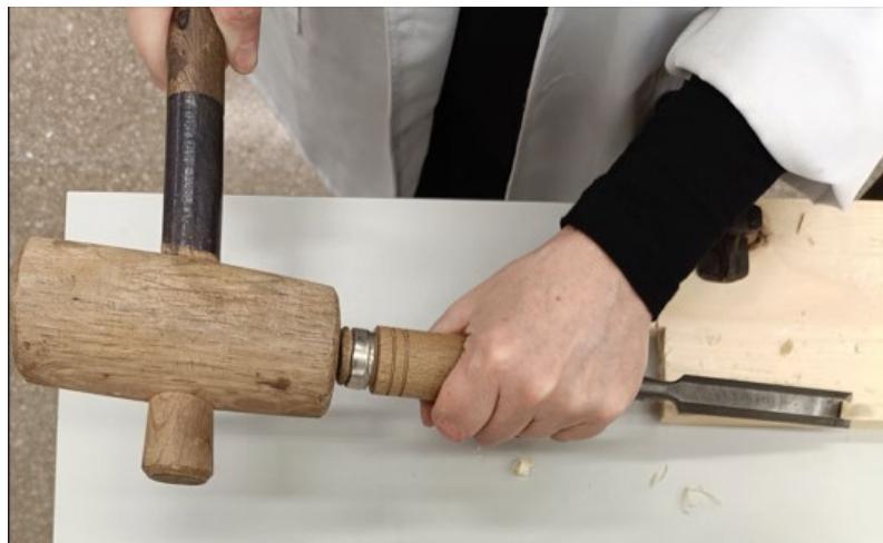
Fig.5 Imatge de l'ús de la maça en el moment de tallar la fusta.
