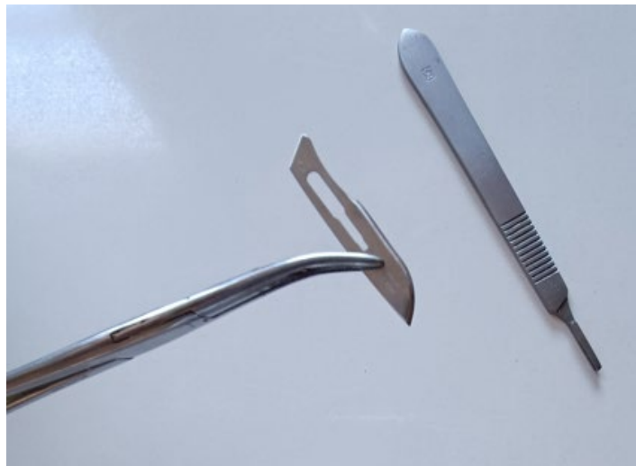
Fig.4 És important subjectar la fulla per aquesta zona per evitar que es trenqui en el moment d'exercir pressió.
