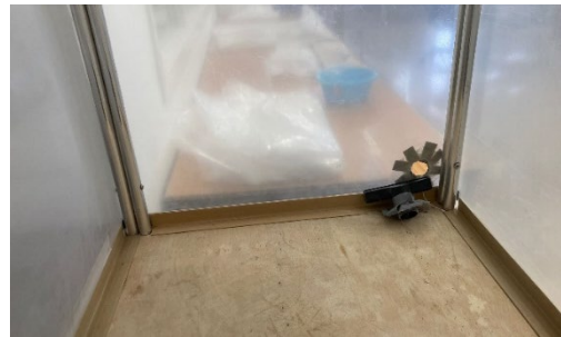
Fig.10. Forat a la part posterior de la Cabina B per col·locar-hi la boca d'un aspirador.
