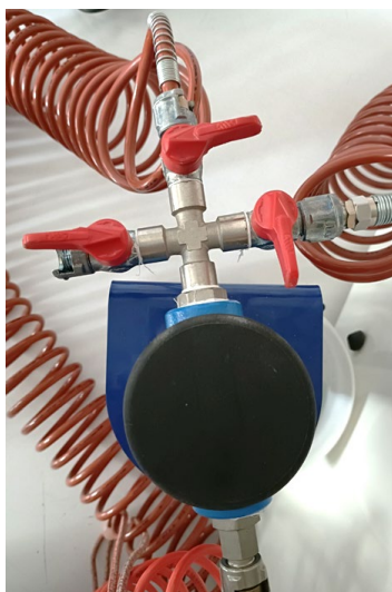
Fig. 6. Deshumidificador amb les tres mànegues d'aire o sortides d'aire tancades.
