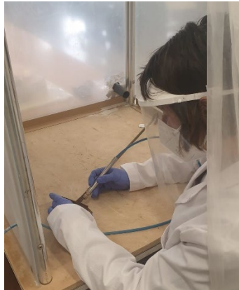
Fig. 13. Ús del microabrasímetre per a la neteja mecànica d'un metall, fent ús dels EPIs pertinents.
