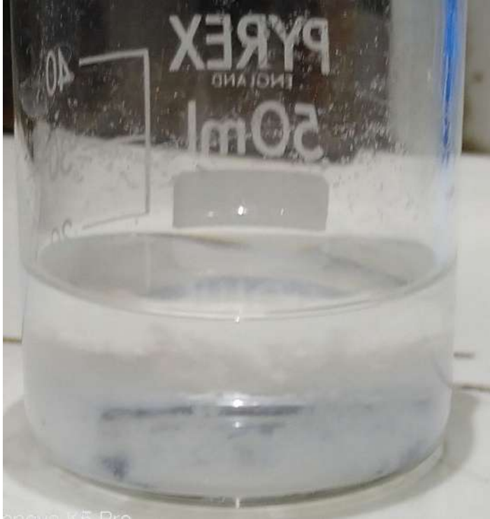
Precipitació del biopolímer en metanol
