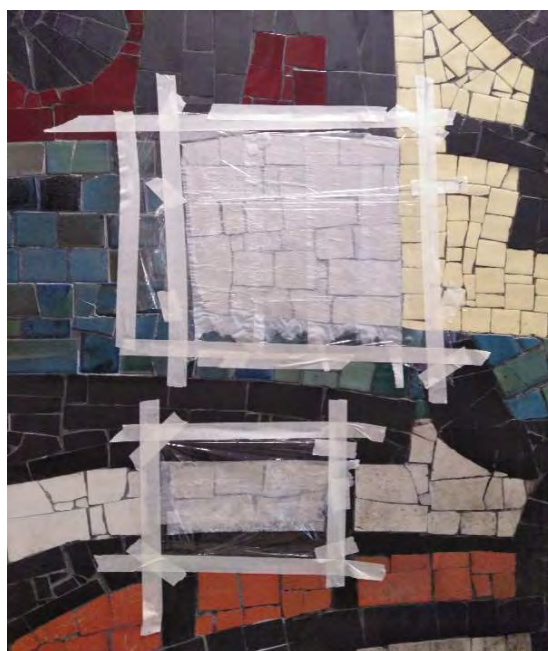
MT 20. Proves de neteja amb film i temps controlat en Les tesselles blanques impregnades.
