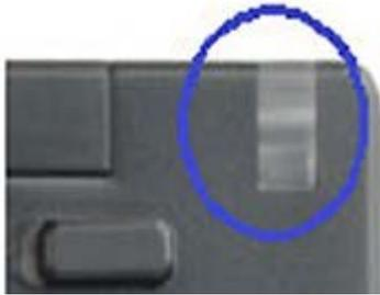
La llum LED situada a l'angle superior dret del telèfon s'anirà mostrant de manera diferent en funció dels diferents estats del telèfon SIP 6865i:
