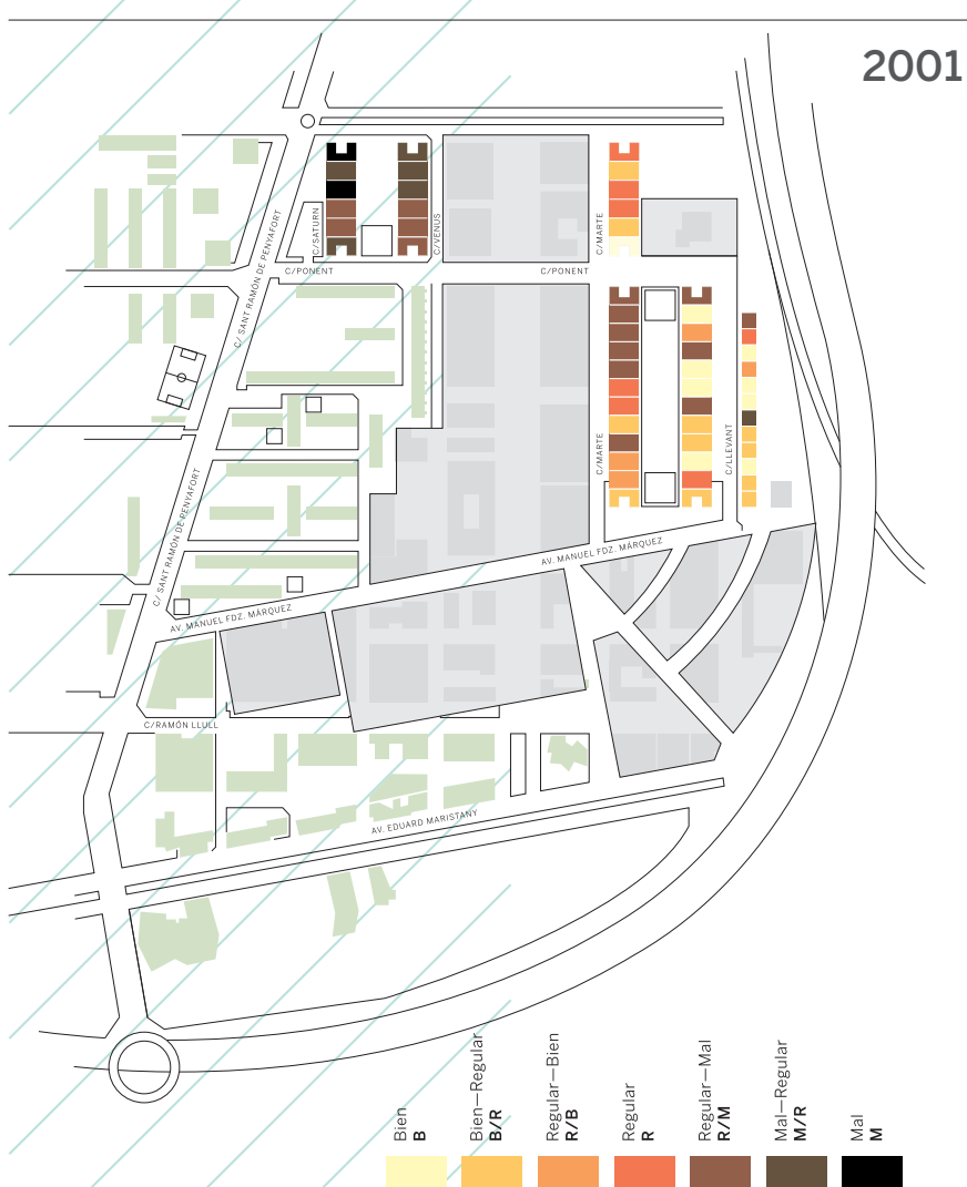
GRÁFICO N°49 Estado general de las escaleras de La Mina Nueva en 2001 Fuente: Fuente: Doncel, Quiroga, Giner y Díez (2001). Apartado 4.1.3 Mapas de las escaleras: representación práctica de las categorías de valoración, ver Anexo N°4
