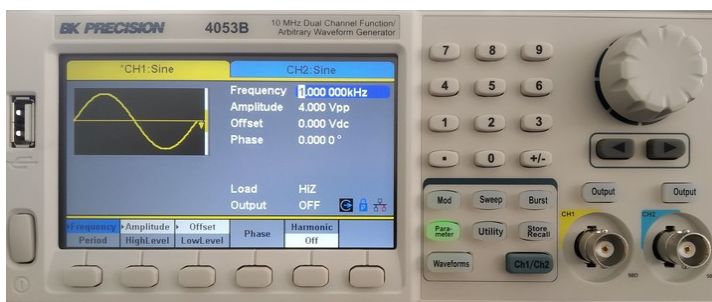
Figura 4: Generador doble de tensions sinusoidals. Cadascuna de les sortides es pot configurar en amplitud, freqüència i desfasament i, a més, permet de combinar-les amb operacions matemàtiques.
