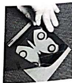
2. Se coloca la plancha con revestimiento fotosensible en el marco de impresión, y sobre ella el negativo, con la emulsión hacia abajo, en contacto con la emulsión de la plancha.
