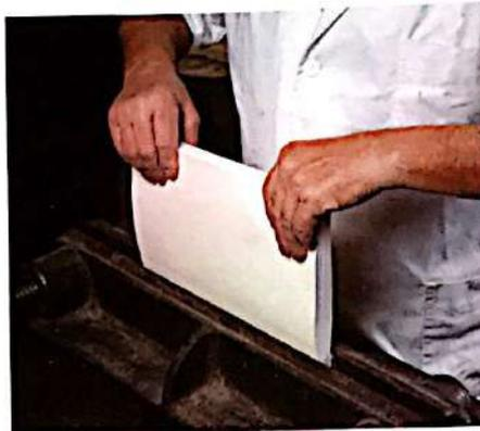
▲ Colocación del libro en la prensa horizontal con el lomo en la parte superior.
