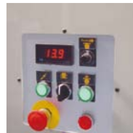
Regulación de la velocidad por "inverter", lectura en visor digital. Speed regulation through INVERTER with digital display.
