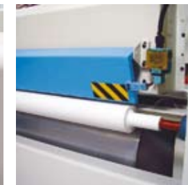
Barrera de seguridad para control espesor de las piezas. Panel thickness Control barrier with emergency stop.
