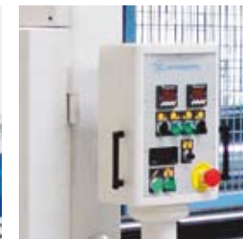
Control digital de la temperatura de los rodillos (opcional). Digital Control of the roller temperature (option).
